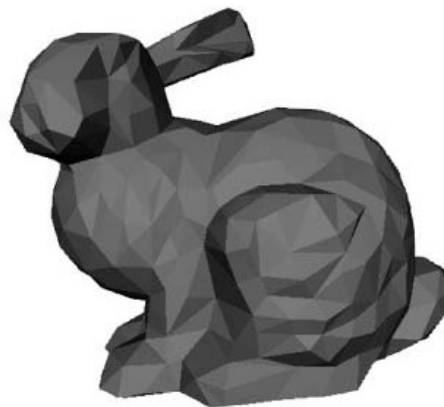
[b] およそ1,000個の三角形からなる簡単化したポリゴン曲面
