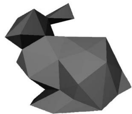
[c] およそ100個の三角形からなる簡単化したポリゴン曲面
