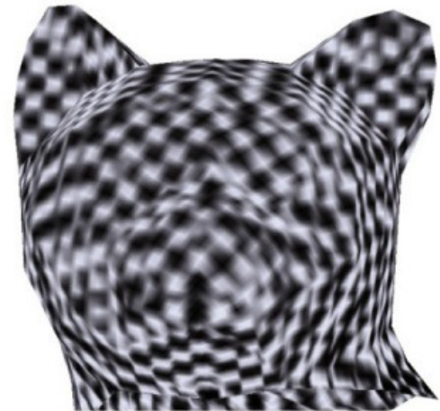
[c] 求められたパラメータに基づく テクスチャマッピング
