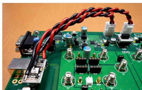
図4 SASEBO-GIIに実装したUSB電源回路
